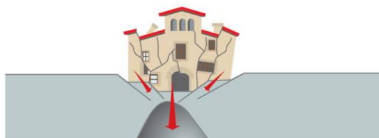
Figura 6: Enfonsaments (subsidència i col·lapses).
