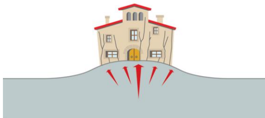
Figura 9: problemàtiques geotècniques (expansivitat).
