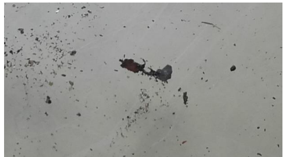
Fig 60. Cos metàl·lic, possible filament procedent d'un cable de coure.
